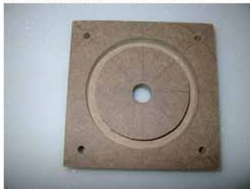
Bild 3.4: Front (Innenansicht) mit Nut zum Einpressen des Abflussrohrs
