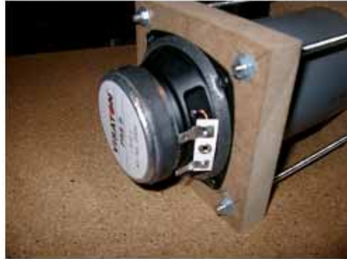
Bild 3.2: Rückansicht der fertigen Messkammer mit Treiber
