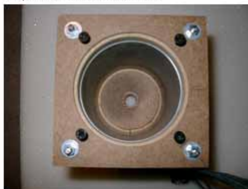
Bild 3.6: Rückwand (Treiberseite), Außenansicht mit Nut zum Einsetzen des Treibers
