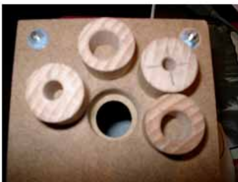
Bild 3.5: Vorderseite (Mikrofonseite) mit Loch für Mikrofonadapter aus 25 mm Rundstab
