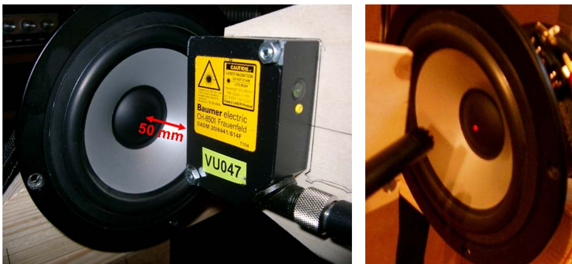
Bild 5: Anordnung von Distanzsensor und Mikrofon vor der Membran
