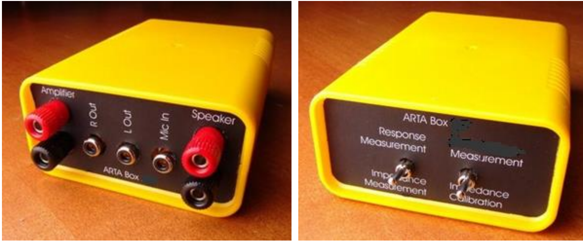
Bild 1.1.4: Die fertig aufgebaute ARTA-Messbox
