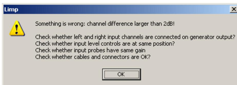
Bild 2.2.6: Fehlermeldung beim Kalibrieren von LIMP
