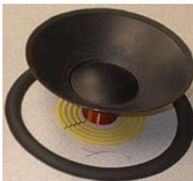
**Bild 3.12:** Bewegte Teile eines Lautsprechers (aus [5])
